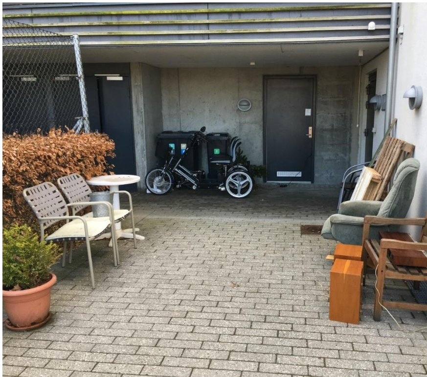
Figur 7 - Dør ind til teknik rum er ikke lukket grundet opladning af Elcykel. Kabler bør ikke udsættes for mekanisk belastning. Samt kunne det konstateres at der var placeret affaldscontainer uden for det dertil indrettet affaldsrum, der er dens egen brandsektion.
